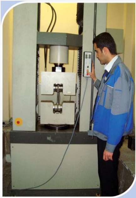
شکل 2: آزمایش محکمی سیخ گول در کشش و فشار
