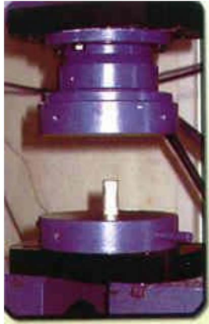
شکل 2: آزمایش محکمی سیخ گول در کشش و فشار
