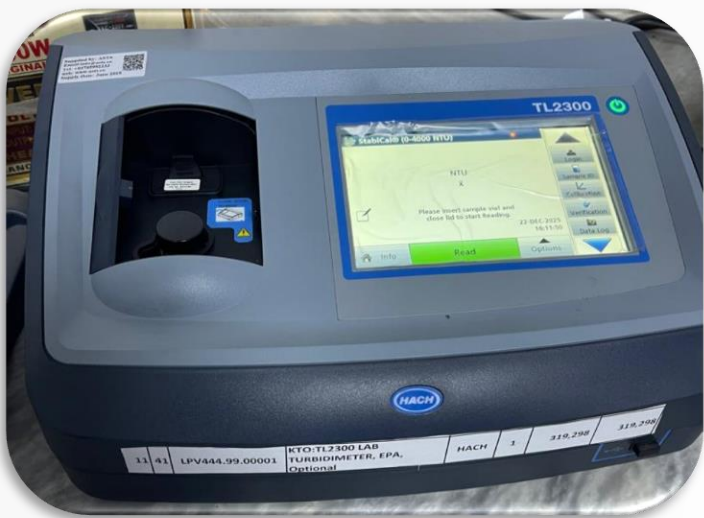
2. شکل د HACH Turbidimeter (TL2300) آلې چې خړوالی ورباندې ازمایښت شوی.
