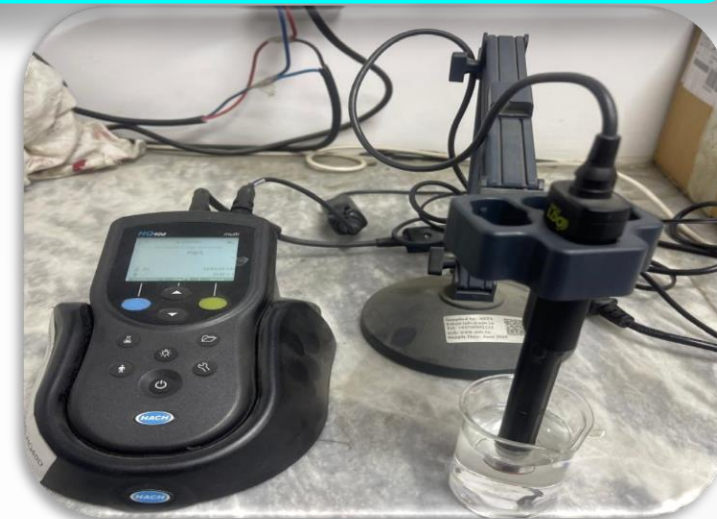
1. شکل د HQ40d Portable Meter آلې چې pH ، EC ، TDS او تودوخه ورباندې ازمایښت شوي دي.
