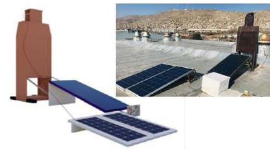
شکل 2- نمایش شیماتیک مکمل دستگاه خشک کن فعال غیر مستقیم آفتابی
